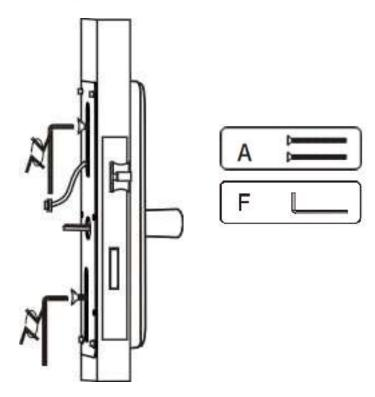
10. Asegúrese de manipular la línea de cableado con cuidado al realizar la conexión. Una vez realizada la conexión, introduzca suavemente el cable en la puerta y coloque el resorte (D) en la varilla de metal cuadrado (C).
