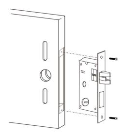
5. Retire la placa de montaje del panel trasero de la cerradura con un destornillador. Esto dejara al descubierto el mecanismo interno de la cerradura.
