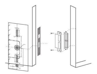
3. Utilice la plantilla de perforación para marcar la puerta y, a continuación, proceda a agujerear los orificios en las posiciones marcadas.
