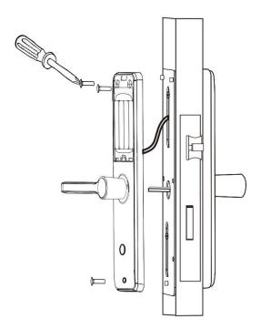
12. Remueva la tapa de las pilas del panel frontal y coloque las pilas nuevas.
