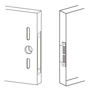
4. Después de marcar los orificios en la puerta, inserte el cuerpo de la cerradura en el orificio con cuidado y apriete los dos tornillos con un destornillador para asegurarse de que el cuerpo de la cerradura queda firmemente sujeto a la puerta.
